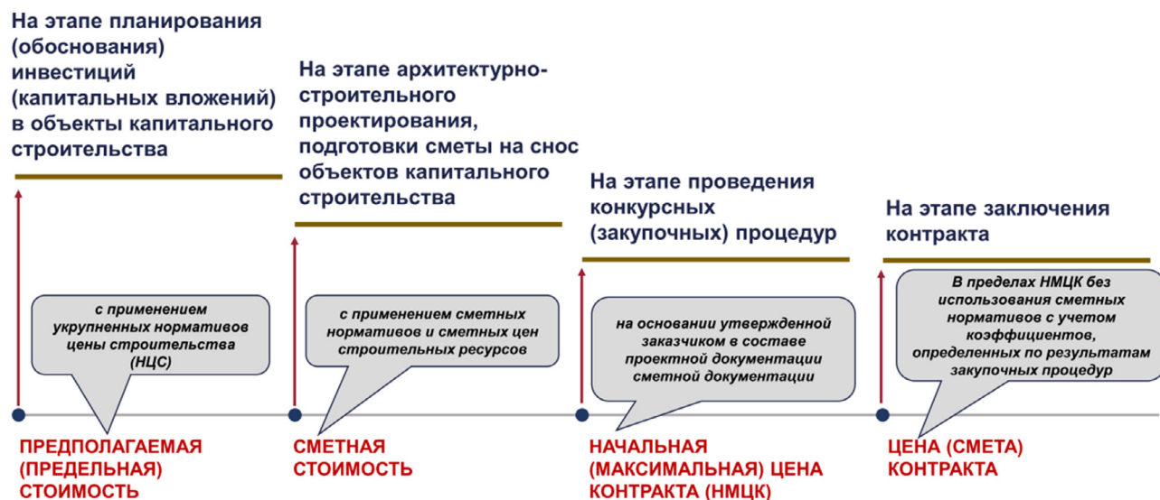
Рис. 1. Этапы определения стоимости в строительстве
