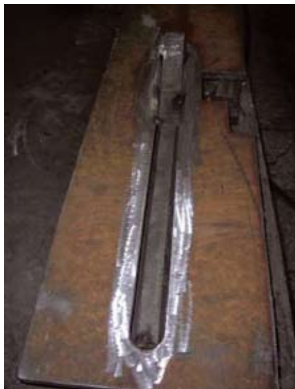
Опытный образец, выполненный в Воронежской НИЛ сварки для отработки режимов сварки узла главной фермы
